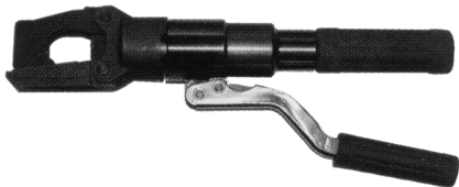
SIMABLOC 55: Ручной гидравлический пресс для использования со сменными матрицами (типа 4E и 5E) для проводов сечением до 95 мм² и максимальным усилием 5000 кгс. SIMABLOC 55 + CR: Пресс с чемоданом. Матрицы заказываются отдельно.
